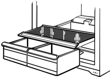
3. Introduire les languettes du couvercle dans les fentes les plus basses de la caisse et pousser vers l'intérieur. Abaisser les pattes de fixation avant en place.
